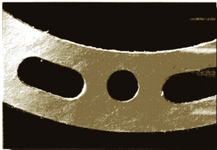
Figura 5 Guarnizioni in amianto
