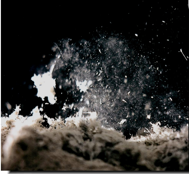
Figura 12 - Friabilità e rilascio fibre
