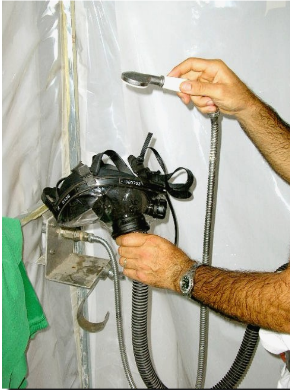
Figura 47 – Lavaggio del respiratore all'interno della doccia
