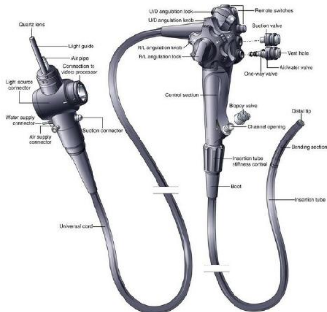
Figura 1 - Gruppo comandi e tratto di inserimento di un videoendoscopio flessibile 7
