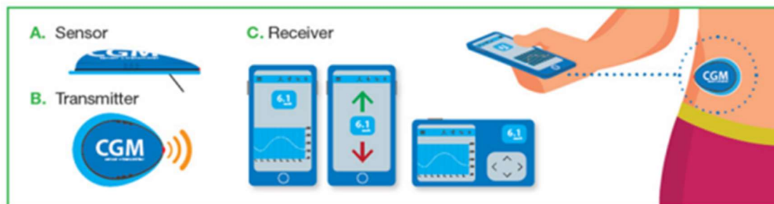
Figura 1 – Elementi compositivi di un esempio di sistema CGM: a sinistra il sensore, al centro il trasmettitore, a destra la app 9
