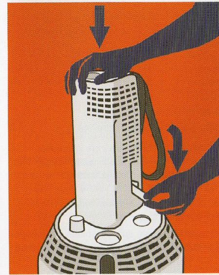
Figura 16 – Leva di riempimento connessa alla valvola di scarico: la posizione di apertura è posta a 90° rispetto alla posizione normale
