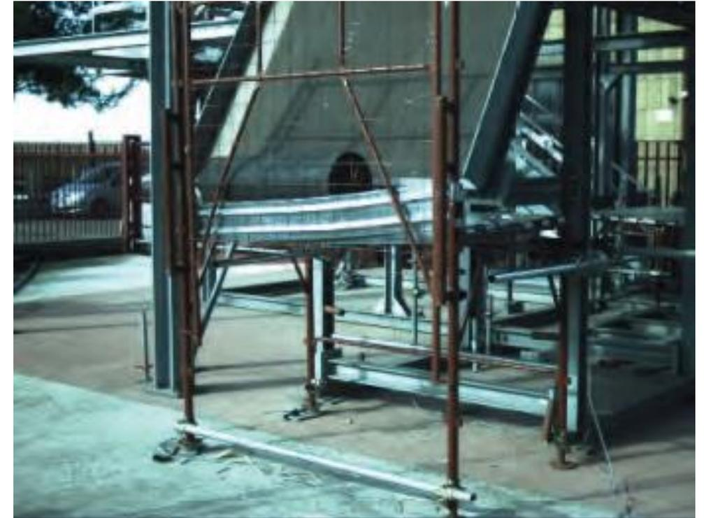
Si osserva comunque che nelle prove sul punto 11, le tavole fermapiEDE montate all'interno della rete metallica seppur da essa ritenute, non hanno resistito all'impatto. Quelle in acciaio si sono sganciate dal montante e quella in legno si è spezzata.
