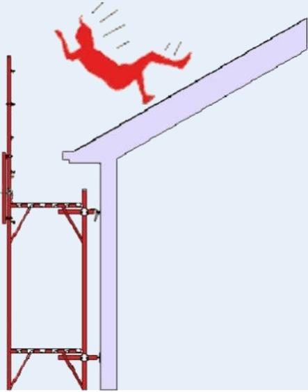
Un **ponteggio di facciata** con **funzione di protezione dei bordi**, utilizzato dai lavoratori che svolgono la loro attività **anche in posizione diversa dell'ultimo impalcato**, per esempio sulla copertura di un edificio, deve essere in grado di:
