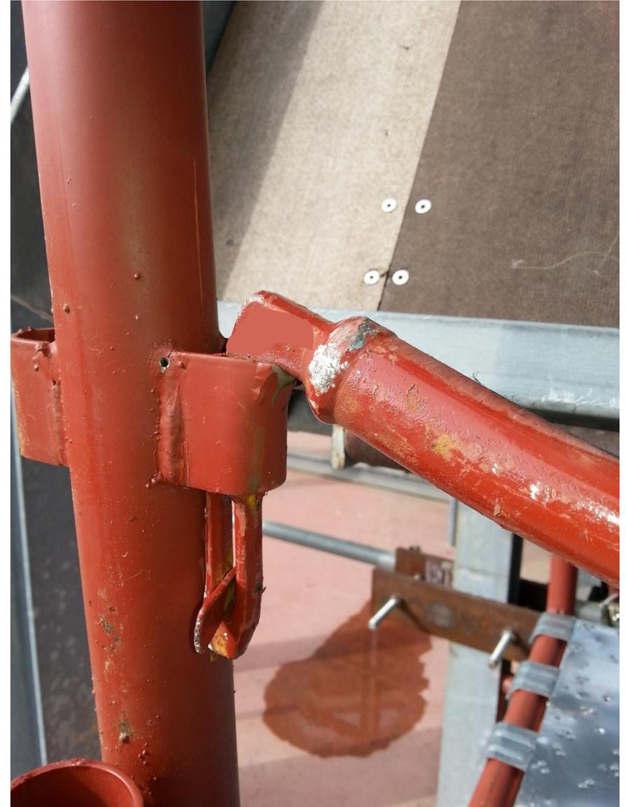
\*\*Nelle configurazioni di prova gli **elementi di ponteggio** utilizzati sono **autorizzati** dal MLPS e appartenenti ad un unico fabbricante. Rispetto alle indicazioni riportate nel libretto, sono stati **modificati i montanti di sommità per consentire l'intensificazione dei correnti** negli schemi CD, CS1 e CS2.
