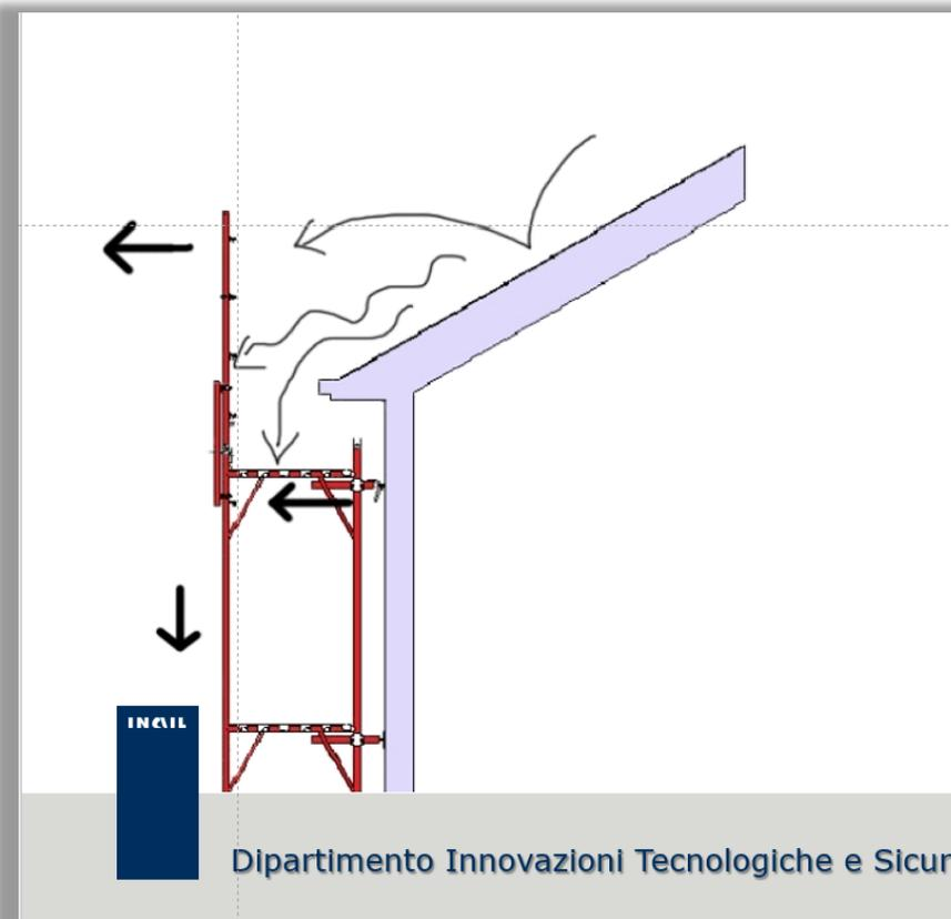
**1. Definizione dei requisiti geometrici:** altezza della protezione, dimensioni degli spazi fra gli elementi del parapetto per evitare il passaggio di persone e cose
