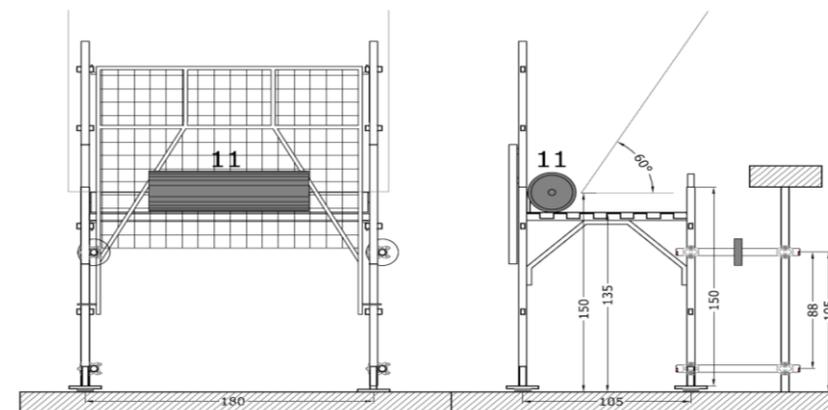
Nel parapetto con protezione continua utilizzato nello schema CSR è stata saldata una **rete metallica** ( $\varphi 4/10 \times 10$ ) sul **telaio** “parapetto” autorizzato.
