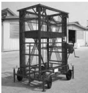
Esempio di ponte mobile sviluppabili su carro ad azionamento manuale
