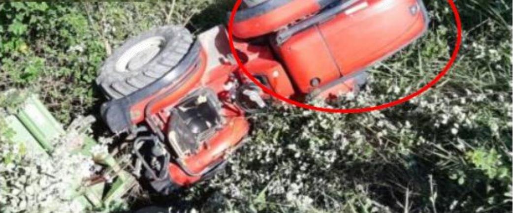
Per lavorare in vigneti e frutteti gli operatori del settore utilizzano trattori dotati di strutture di protezione abbattibili
