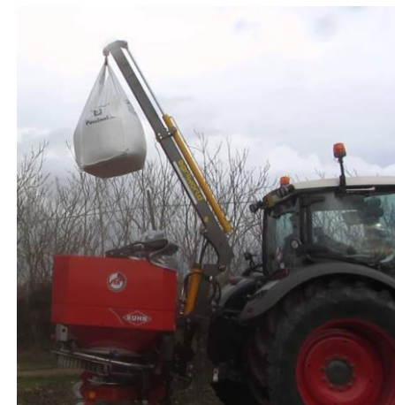
Sollevatore idraulico intercambiabile a braccio fisso abbinato ad uno spandiconcime
