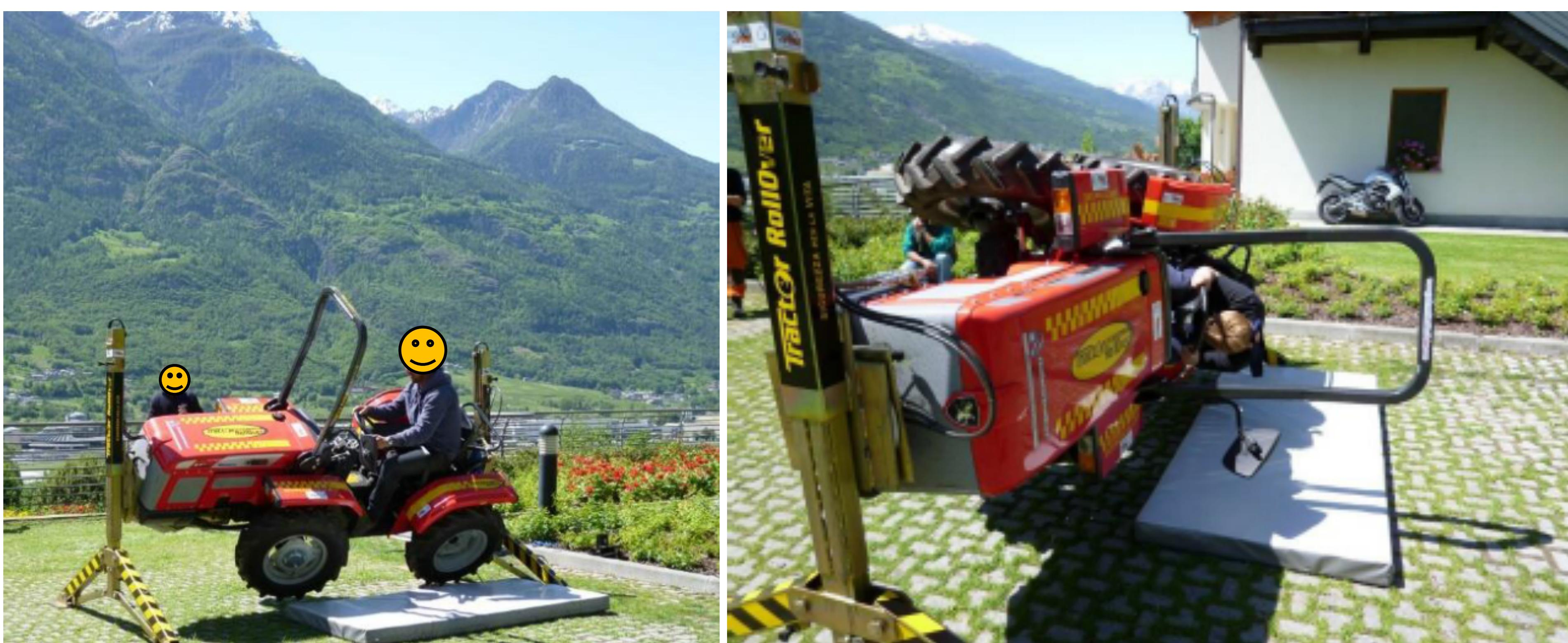
*Si tratta di un vero trattore agricolo su cui è stata costruita in maniera inedita ed unica, una struttura per farlo ribaltare, in virtù di una volontà di ricreare una situazione di rischio non coperta da nessun altro macchinario o simulatore.*
