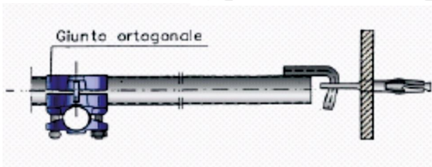
Fig. 1: Ancoraggio a tassello con tubo a gancio
