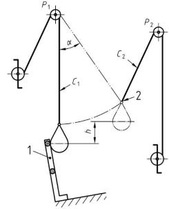
L'impatto è ottenuto dalla caduta pendolare del sacco di 50 kg di peso conforme alla EN 596. L'altezza di caduta, h, è calcolata per ottenere una  $Ec = 1100 \, J$  (h = 2,25 m) per testare la parte bassa del bordo di protezione e una  $Ec = 500 \, J$  (h = 1,0 m) per testare le altre zone del parapetto.
