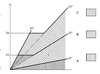
Per le classi B e C la norma impone di eseguire test di impatto sui prototipi per verificare la capacità di assorbimento dell'energia cinetica dovuta alla caduta dei corpi
