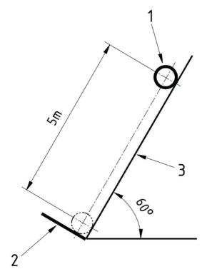
L'impatto è ottenuto dalla caduta per rotolamento per 5,0 m del rullo di 75 kg di peso conforme alla EN 13374. Per questa configurazione l'energia sviluppata è pari a Ec = 3185 J
