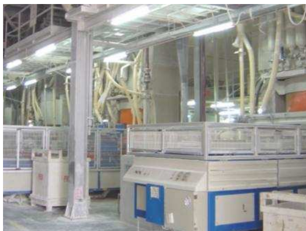
Tubazione principale e calate per l'aspirazione delle polveri aerodisperse delle presse,
