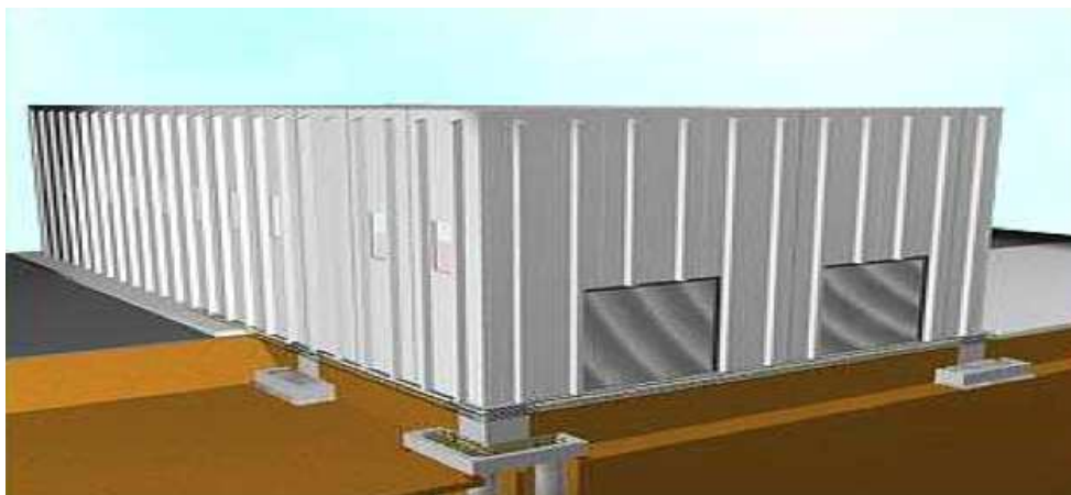
Figura 3.9. Rappresentazione grafica di uno spaccato assometrico di un capannone industriale realizzato con fondazioni prefabbricate di tipo a plinto
